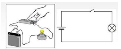
Para que se estabeleça corrente elétrica é necessário a existência de um circuito através do qual estas cargas possam se movimentar.
