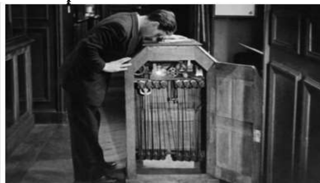
Um homem assiste filmes no cinetoscópio, que se encontra aberto e é possível ver os rolos de filmes.
