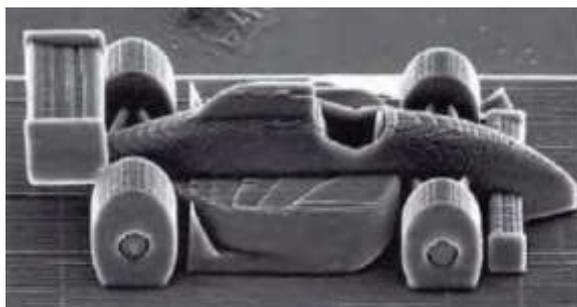
A escultura apresentada é uma miniatura de um carro de Fórmula 1, com 100 micrômetros de comprimento. Um micrômetro é a milionésima parte de um metro.
