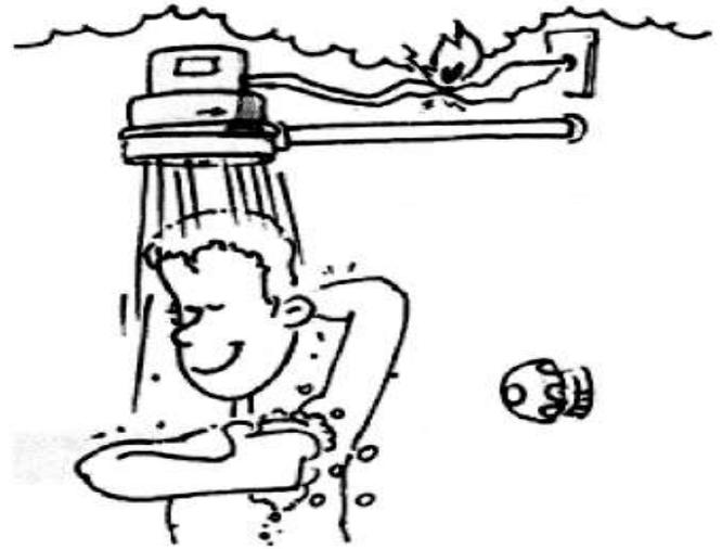
O superaquecimento da fiação, devido a esse aumento da corrente elétrica, pode ocasionar incêndios, que seriam evitados instalando-se fusíveis e disjuntores que interrompem essa corrente, quando a mesma atinge um valor acima do especificado nesses dispositivos de proteção.
