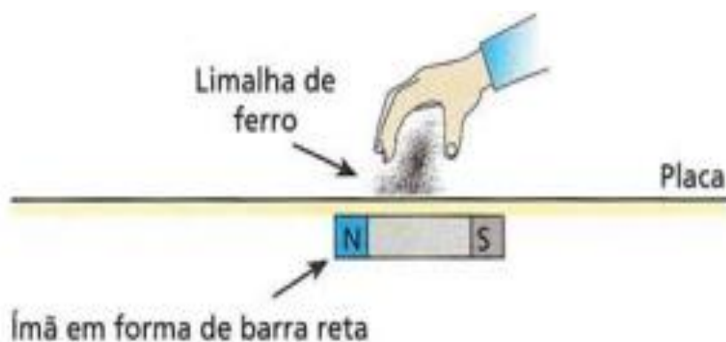
Figura 12: Limalha sobre o papel
